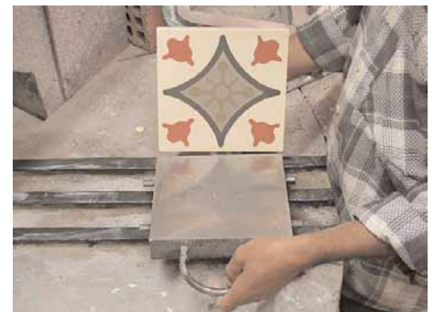
Am Ende wird die Fliese aus der Pressform vorsichtig herausgelöst und kontrolliert.
