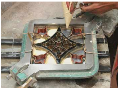
Die Masse aus Marmorstaub, Felsgranulat, Zement und Farbstoffen wird in die Kammern der Metallform gefüllt.
